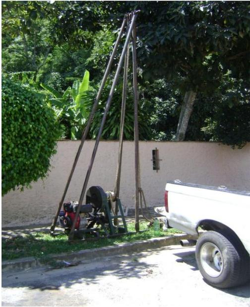
**Figura 42. Fotografía de la máquina para perforación SPT en el sitio de perforación.**
