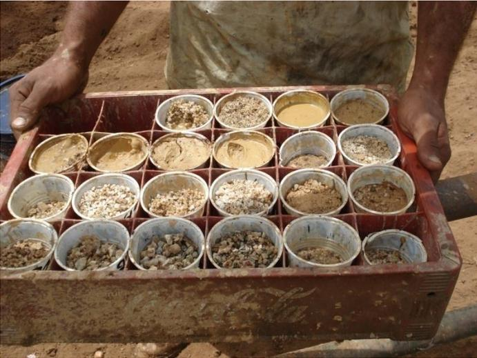
Figura 38. Muestras de Rippios obtenidas durante la perforación del pozo.
