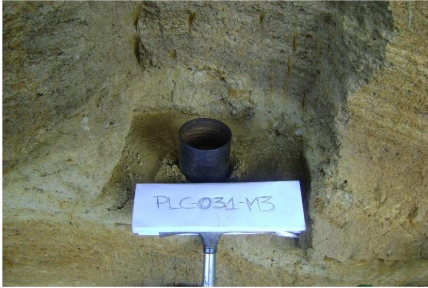
**Figura 27. Fotografía de toma de muestra en el sub-horizonte IB.**
