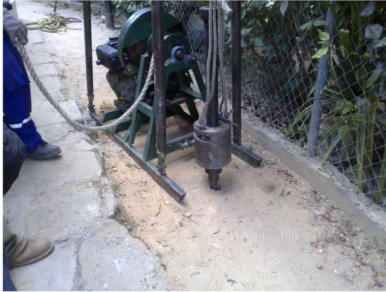
**Figura 22. Detalle de Perforacion SPT.**
