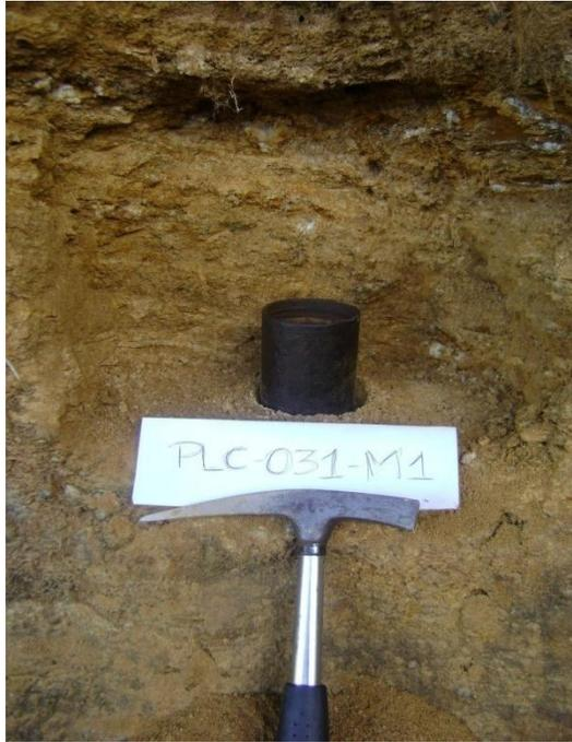
**Figura 28. Fotografía de toma de muestra para el horizonte IA.**
